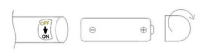
2. Legen Sie die Batterie (1 x AA) ein, schließen Sie den Schalterdeckel und drehen Sie ihn im Uhrzeigersinn, um ihn wieder an seinem Platz zu befestigen.
