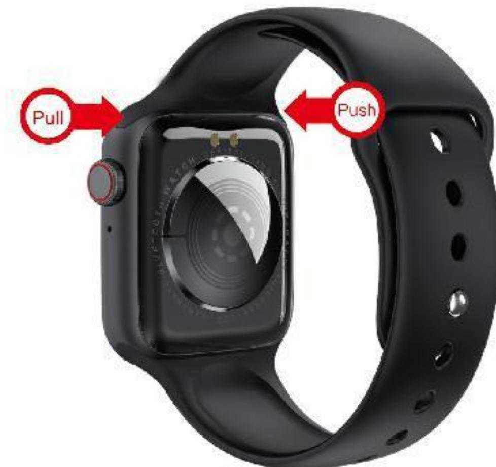
Cambiare il cinturino dell'orologio: Tirare in avanti con una mano, contemporaneamente spingere in avanti con l'altra mano, il cinturino può così essere facilmente rimosso. Per collegare l'orologio a un telefono, scaricare prima l'applicazione "M Active" sul telefono utilizzando i seguenti metodi:
