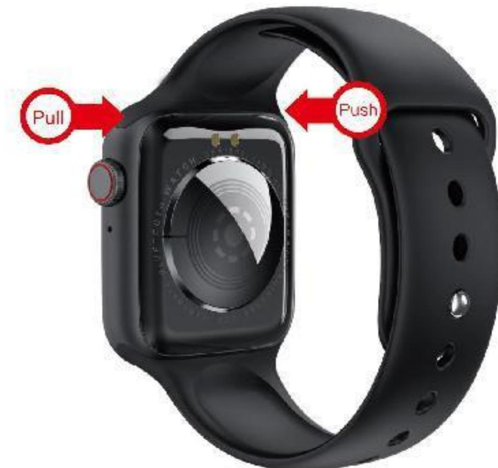
Zamjena remena na satu: Remen lako možete skinuti tako da jednom rukom povučete naprijed, a drugom rukom istovremeno gurnete naprijed.
