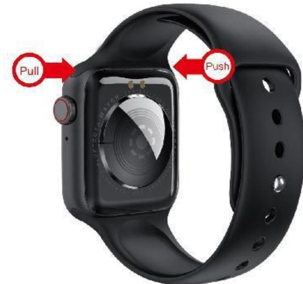
Uhrenarmband wechseln: Das Armband lässt sich leicht abnehmen, indem man es mit einer Hand nach vorne zieht und gleichzeitig mit der anderen Hand nach vorne drückt.
