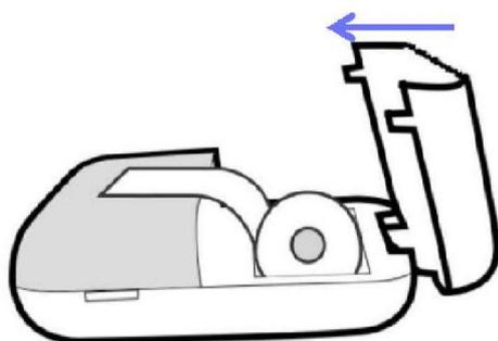
**2.** Cierre la cubierta, ahora el dispositivo puede absorber papel automáticamente durante el uso normal.
