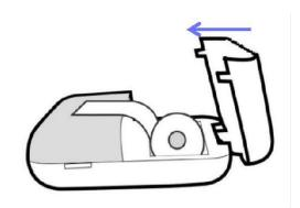
2. Schließen Sie die Klappe, jetzt kann das Gerät bei normalem Gebrauch automatisch Papier aufnehmen.
