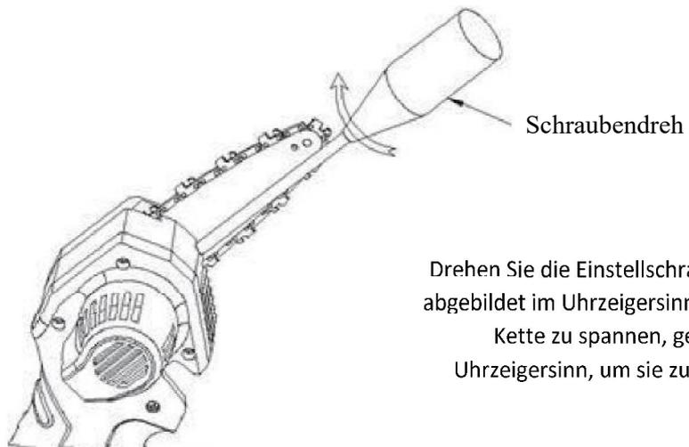
Drehen Sie die Einstellschraube wie abgebildet im Uhrzeigersinn, um die Kette zu spannen, gegen den Uhrzeigersinn, um sie zu lockern.
