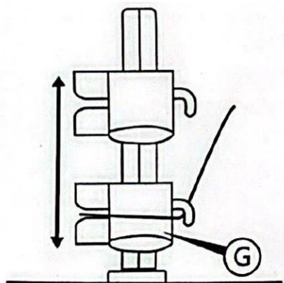
7. Sada ste spremni za namotavanje konca. Provjerite je li poklopac (B) na mjestu, a zatim pritisnite gumb za početak punjenja. Upotrijebite kliznu vodilicu (G) da ravnomjerno namotate konac na špulicu.
