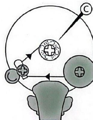
6. Far passare il filo attraverso la guida scorrevole (G) e avvolgerlo sul rullo avvolgitore. Fissare il filo avvolgendolo un paio di volte in senso antiorario per farlo partire.
