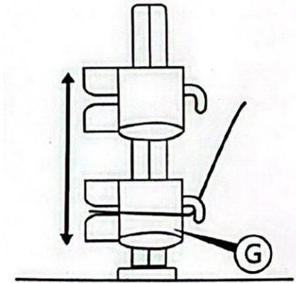
7. Está agora pronto para carregar o fio. Assegure-se de que a tampa (B) está no lugar e prima o botão para iniciar o carregamento. Utilize a guia deslizante (G) para enrolar uniformemente o fio na bobina.
