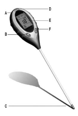
A.**PH/TEMP-TASTE**: Modusschalter zum Einstellen des Modus für pH-Wert, Temperatur oder Feuchtigkeit.
