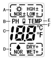
A. Anzeigebereich für die Sonnenlichtintensität: Zeigt 9 Stufen von LOW- bis HGH+ an, die die zunehmende Menge und Qualität des Lichts anzeigen.
