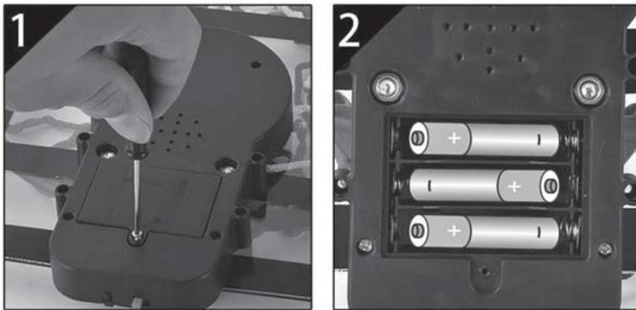
1. Schrauben Sie das Batteriefach ab.
