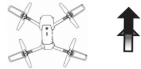
Antes da descolagem, assegure-se de que a frente da aeronave, com o lado da câmara virado para si, e prima um botão para estabelecer a direção de voo no modo sem cabeça. Esta funcionalidade melhora a facilidade de controlo ao simplificar a orientação do drone em relação ao telecomando, proporcionando uma experiência de voo mais intuitiva.
