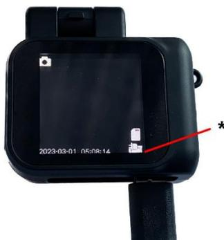
Durante la ricarica, l'icona di carica lampeggerà. Una volta completamente carico, l'icona scomparirà (come mostrato in figura).
