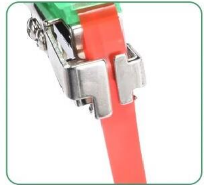
SCHRITT 3: Ziehen Sie das Band und schieben Sie es zwischen die Metallführungen, um es zu sichern.
