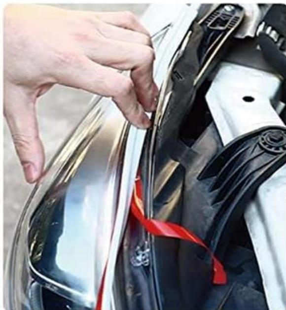
**Pasul 3:** Determinați care conexiune ACC a lămpii de zi vine prima. Asigurați-vă că există o tensiune de 12 V, cu un curent de 10 A, și aveți grijă să nu tăiați niciun fir.
