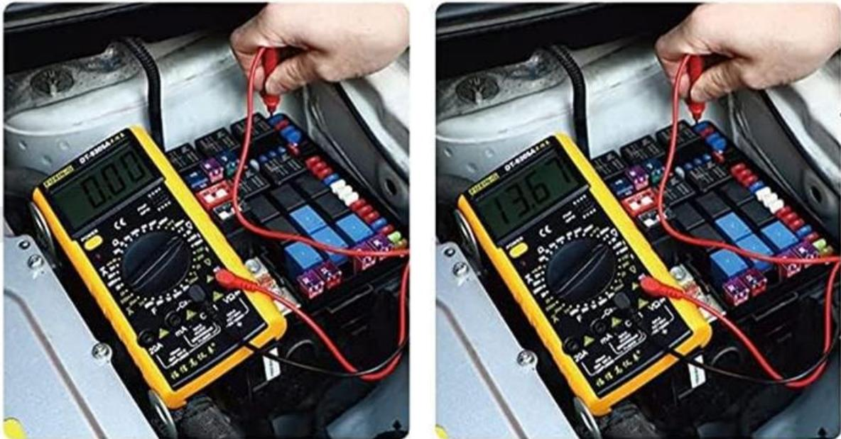
**Стъпка 4:** Свържете проводника към автомобила (червеният проводник трябва да се свърже към ACC (+), а черният - към отрицателния заземен полюс на акумулатора на автомобила) .
