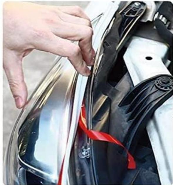
**Βήμα 3:** Καθορίστε ποια σύνδεση ACC του λαμπτήρα ημέρας έρχεται πρώτη. Εξασφαλίστε τάση 12V, με ρεύμα 10A, και προσέξτε να μην κόψετε κανένα καλώδιο.
