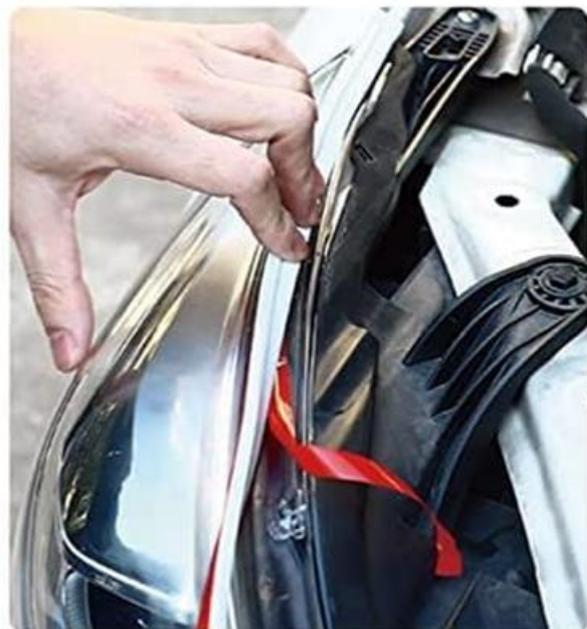
**Korak 3:** Odredite koja veza dnevnog svjetla ACC dolazi prva. Osigurajte napon od 12V, s strujom od 10A, i pazite da ne oštetite žice.
