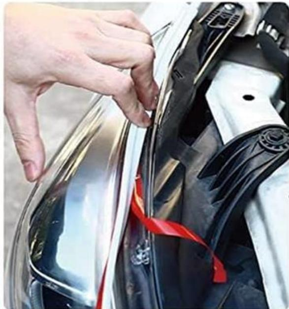
**3. lépés:** Határozza meg, hogy melyik nappali menetfény ACC-csatlakozás következik először. Biztosítsa a 12V-os feszültséget, 10A áram mellett, és ügyeljen arra, hogy ne vágja el a vezetékeket.
