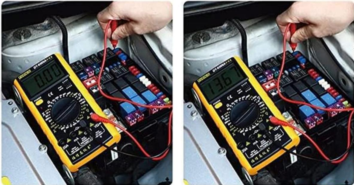
**Étape 4 :** Connectez le fil à la voiture (le fil rouge doit être connecté à l'ACC (+) et le fil noir au pôle de masse négatif de la batterie de la voiture) .
