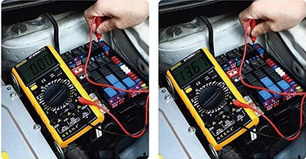
**Paso 4:** Conecte el cable al coche. (El cable rojo debe conectarse al ACC (+), y el cable negro al polo negativo a tierra de la batería del coche) .
