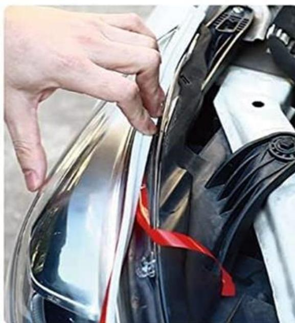
**Fase 3:** Determinare quale connessione ACC della luce diurna viene prima. Assicurarsi che la tensione sia di 12 V, con una corrente di 10 A, e fare attenzione a non tagliare i fili.
