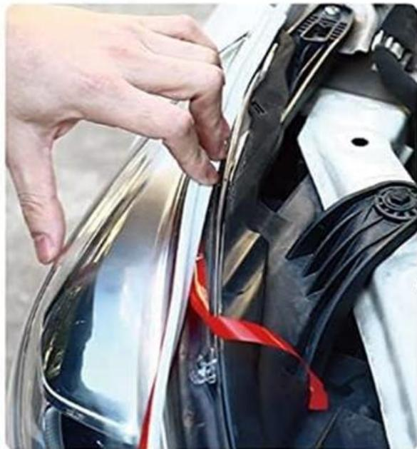
**Stap 3:** Bepaal welke ACC-aansluiting voor dagrijverlichting eerst komt. Zorg voor 12V spanning, met een stroom van 10A, en zorg ervoor dat je geen draden doorknipt.
