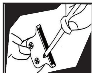
Pričvrstite vijke križnim odvijačem. Napravite čvrst spoj kako biste sprječili pad glave oštice.
