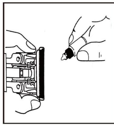
Prije ili nakon upotrebe, održavajte oštice kapanjem malo ulja za oštice (nije uključeno) na oštice dok su uključene. Obrišite suhim papirnatim ručnikom nakon isključivanja uređaja.
