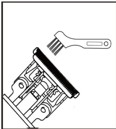
Nakon upotrebe, očistite oštice isporučenom četkom za čišćenje.
