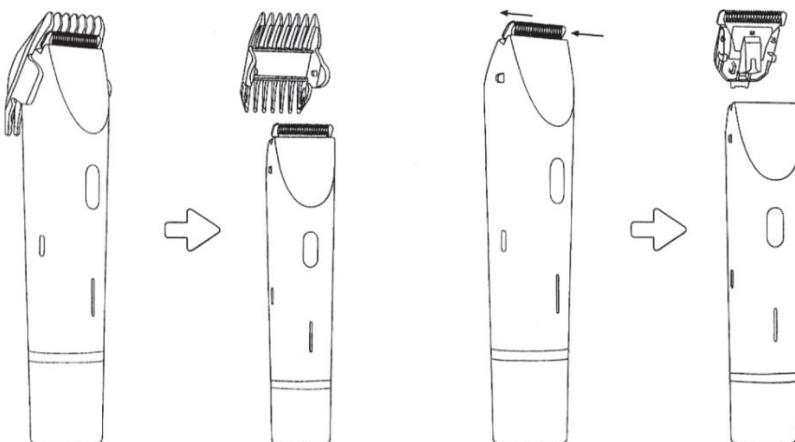
3. **Rimozione della testina rotonda:** Ruotare la testina in senso antiorario fino a sbloccarla, quindi rimuoverla.
