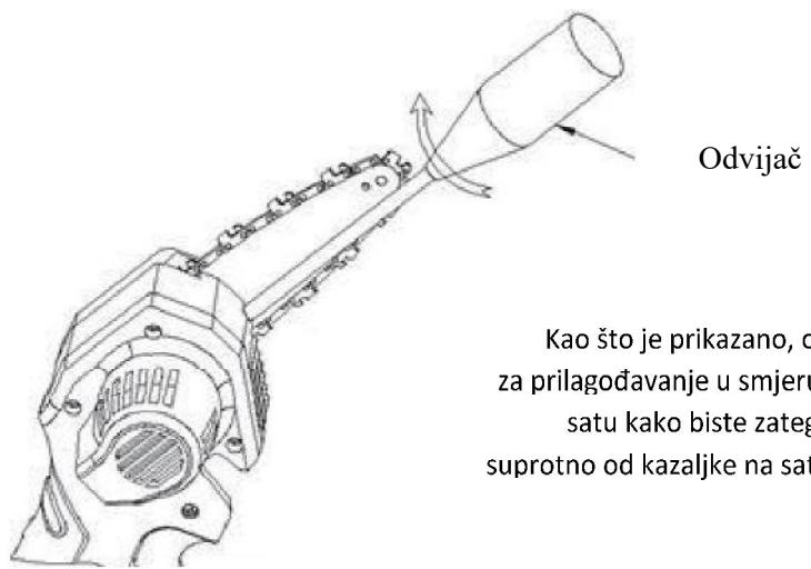
2. Otpustite kompresijsku maticu. Kao što je prikazano na slici, vijak okrećite u smjeru kazaljke na satu kako biste zategnuli lanac ili suprotno od kazaljke na satu kako biste ga otpustili.
