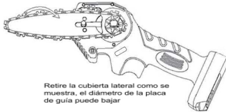
Retire la cubierta lateral como se muestra, el diámetro de la placa de guía puede bajar
